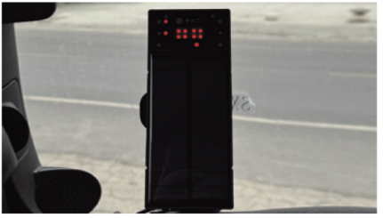
可视化警示灯提醒，实时报警 1.中间信号灯常亮且对应轮位指示灯亮起，表示该轮位正在补气 2.中间信号灯闪烁且对应轮位指示灯亮起，表示该轮位已经大泄露需立即停车检查。 3.中间信号灯下方左侧为充电指示灯，充电时为红灯，充满时亮绿灯 4.中间信号灯下方右侧为电源指示灯，间隔3秒闪烁为正常工作状态，快速频闪为低电量提醒
