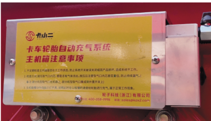
气动增压泵 整套系统的核心部件，将刹车储气瓶的压力从8KG增压到16KG,实时为轮胎充气到设定的胎压值
