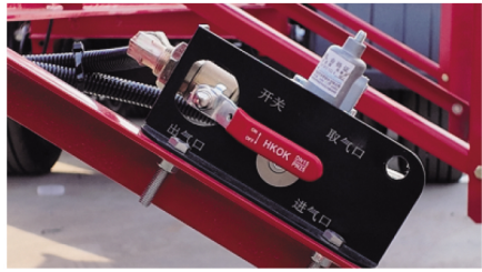
安全阀机制，稳定气源 当刹车气压低于6.8公斤时，安全阀会自动关闭，保证刹车气源正常供给时才能自动充气，故不影响卡车刹车系统
