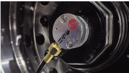
高速气动旋转接头 系统和轮胎连接的核心部件，采用动态密封机制，增压气体从特种轴内孔，通过气嘴延伸管，输送到每个轮胎
